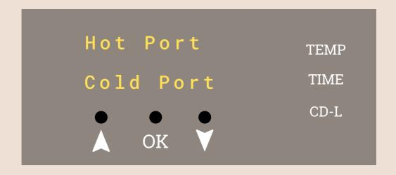
Nota: Hay dos puertos pequeños en la parte frontal de la pantalla digital. Si la temperatura real es más baja que la del controlador digital que se muestra, puedes ajustar el "puerto caliente"; En el sentido de las agujas del reloj para elevar la temperatura y en sentido antihorario para reducirla.
